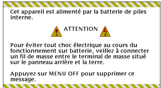
Figure 1. Avertissement affiché par les oscilloscopes de la série TDS3000 lorsqu'ils fonctionnent sur batterie.
